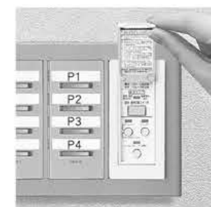
1 打開壁面設定開關 (WRT5850-8) 的蓋板。
