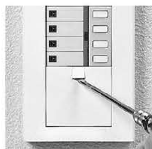
1 鬆開設定單元的蓋板螺絲，將蓋打開。
