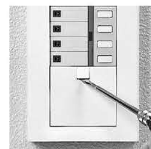
1 鬆開設定單元的蓋板螺絲，將蓋打開。
