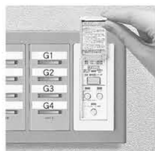
1 打開壁面設定開關 (WRT5850-8) 的蓋板。
