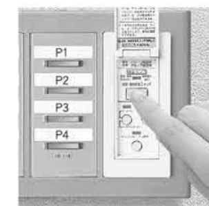
2 按下設定按鈕將系統切換成設定模式。 (紅色LED亮)。
