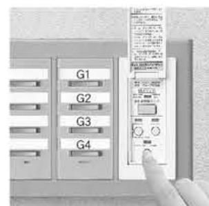
4 在執行初始設定之前，請先按下重置控制按鈕。 (紅色LED亮)。 註：若您正在確認或執行變更，切勿執行此步驟4。
