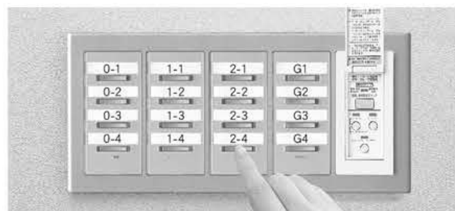
5 按下個別開關選擇要納入群組控制的負載。 (LED (紅) ON..... 負載已納入群組之中) (兩LED (紅、綠) OFF..... 負載未納入群組之中) 重複步驟3、4及5以進行其他群組控制設定。 ※關於定時執行時間設定，請參照下述方法。
