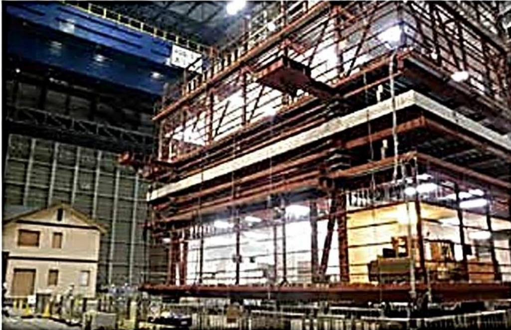
(独)防災科学技術研究所「E-ディフェンス」での耐震性確認試験
